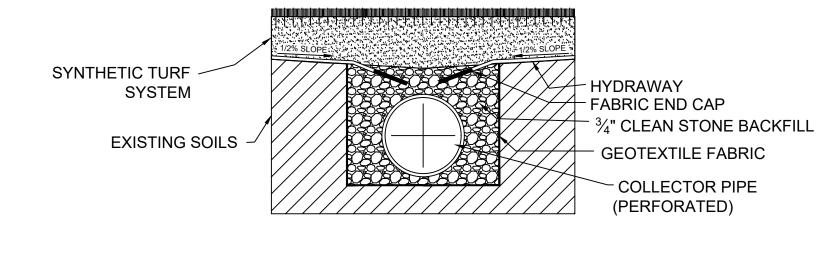
TYPICAL DRAIN TERMINATION DETAIL
