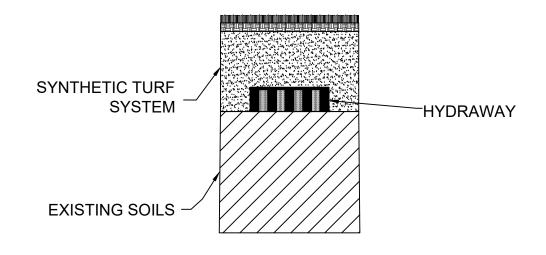
TYPICAL SUBSURFACE DRAIN DETAIL
